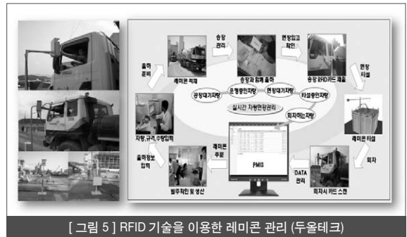
[그림 5] RFID 기술을 이용한 레미콘 관리 (두울테크)
